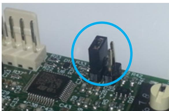
Figura 28:Jumper de la entrada de control remoto.
